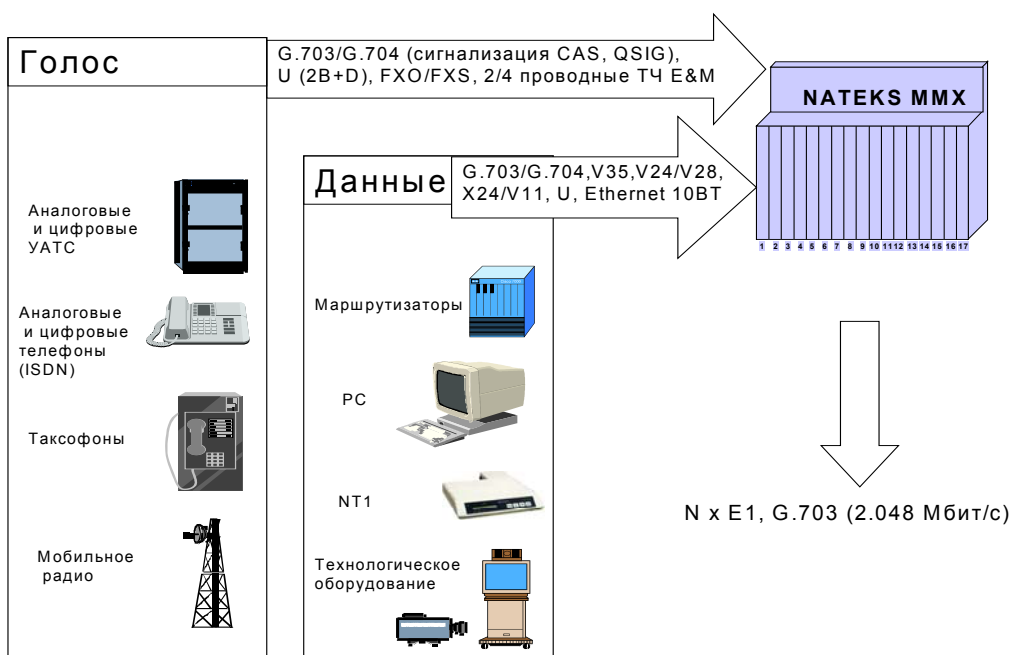
Рис. 1.1. - Применение мультиплексора NATEKS MMX
