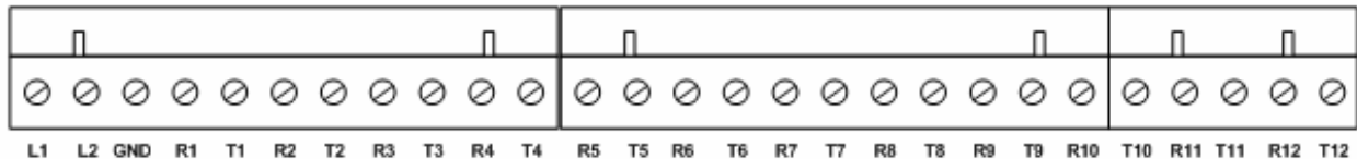
Рис. 4.3. Подключение абонентского оборудования.
