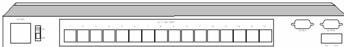
Рисунок 2.2 – Задняя панель FG-FOM16E-OG с симметричными разъемами портов E1 RJ45 120 Ом
