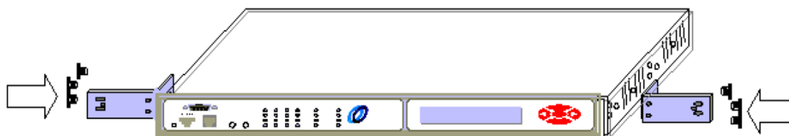
Рис 3.2. Установка в стойку 23”.
