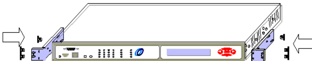
Рис 3.1. Установка в стойку 19”.
